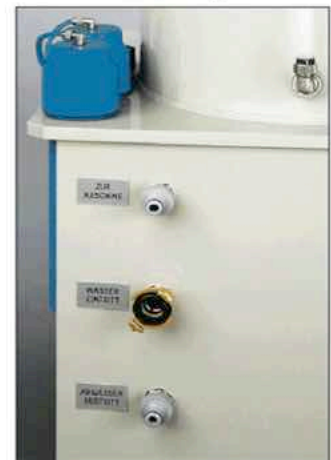
Detail: Wasseranschluss, Anschluss zur Maschine und Kanalisationsanschluss
